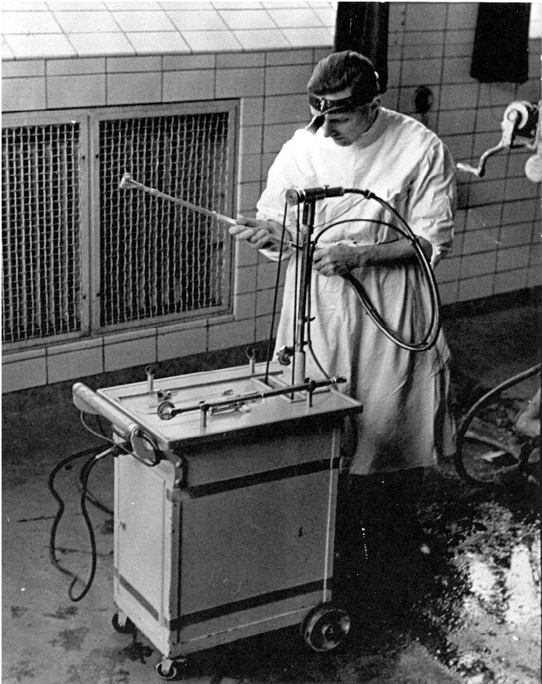
Abb. 24 Ankopplung eines Schleifhandstücks an die biegsame Welle des fahrbaren elektrischen Antriebsgeräts in der Heeresleherschmiede
